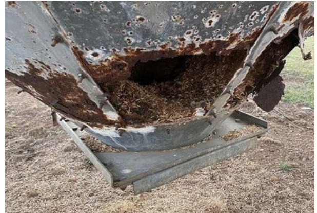
Силосы из стекловолокна устойчивы к коррозии! Соль и аммоний в кормах, в сочетании с конденсатом приводят к коррозии, к которой композитные материалы устойчивы.
