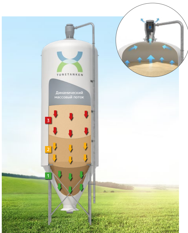
Эффективная система заполнения с циклоном и вентиляцией распределяет среду и гарантирует, что она не будет слишком плотно загружена, таким образом, минимизируется риск образования конденсата.
